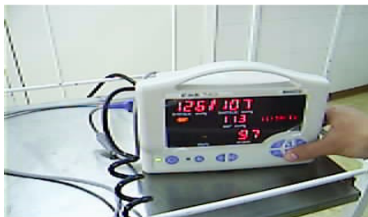
Figura1 Equipo oscilo métrico. Mod. CAS 740. Fuente: (RUIZ, 2005)
